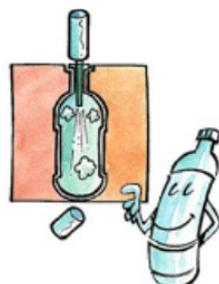
Cela commence par l'extrusion d'un tube.
