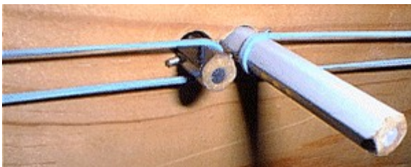
Les axes sont des baguettes maintenues par des pointes et des élastiques.
