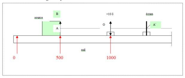
Placer l'objet sur la graduation 500mm du banc. Déplacer l'écran pour obtenir une image nette. Noter sa position dans un tableau puis compléter celui-ci en donnant à la distance lentille-objet les différentes valeurs indiquées.(l'objet AB a une hauteur de **16mm**)
