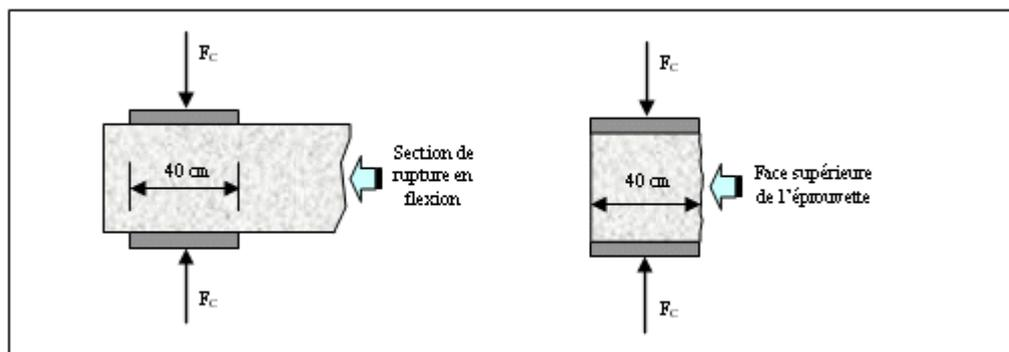
Fig. 5.4.7 : Dispositif de rupture en compression.
