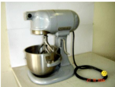
Fig. 5.5.3 : Malaxeur normalisé pour pâte et mortier normal
