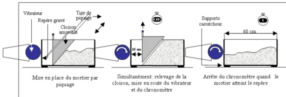
Fig. 5.4.3 : Principe de fonctionnement du maniabilimètre B
