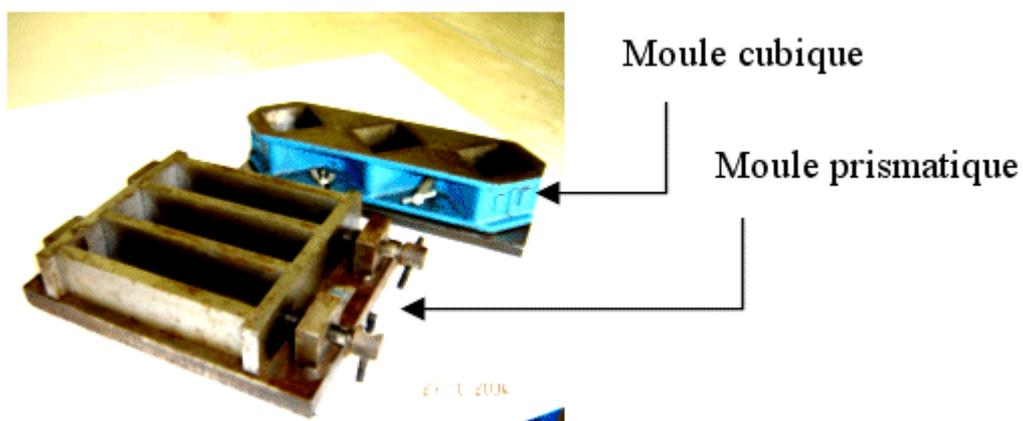
Fig. 5.4.5 : Moule pour moulage des éprouvettes de mortier
