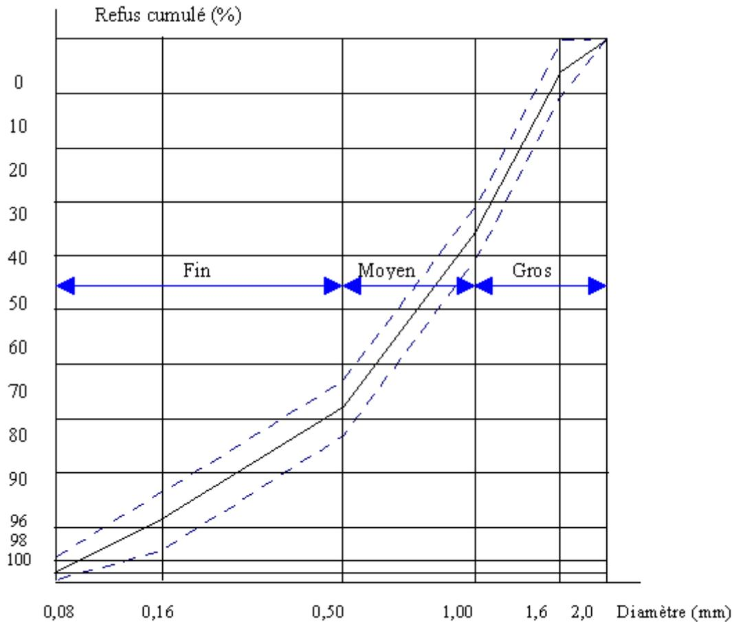
Fig. 5.4.1 : Courbe granulométrique du sable normalisé selon les normes Afnor
