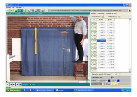
Réaliser le pointage de la vidéo «15 parachute.avi» avec le logiciel Avimeca dans le
