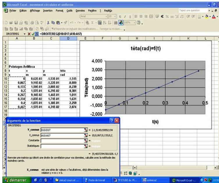
Les points s'alignent ...q est donc une fonction affine de t, le mouvement est donc circulaire et uniforme
