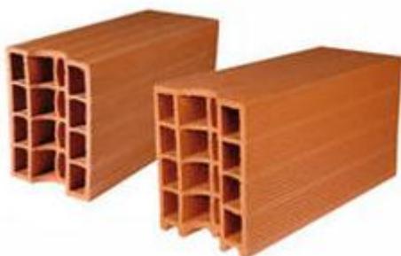
Ils sont réalisés industriellement par filage. L'axe des trous est perpendiculaire au lit de pose et la superficie des trous inférieure à 40% de la section total de la brique.
