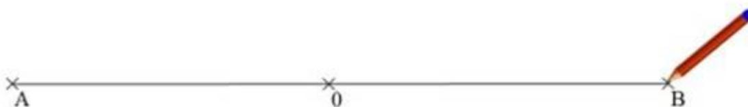
Placer la pointe du compas (ou le départ d'un cordeau) sur 0 et tracer les points x et x' à distance égale de 0.
