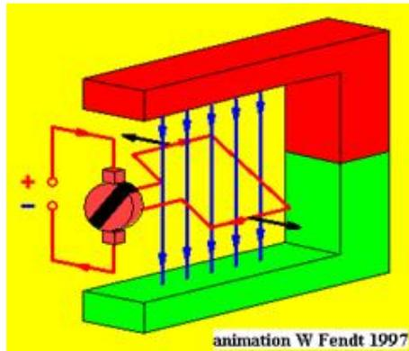
Le moteur le plus simple est constitué d'un cadre rectangulaire MNPQ pouvant tourner autour de l'axe  $x'x$  (voir schéma ci-dessous). Les extrémités du circuit sont reliées au collecteur cylindrique d'axe  $x'x$ .
