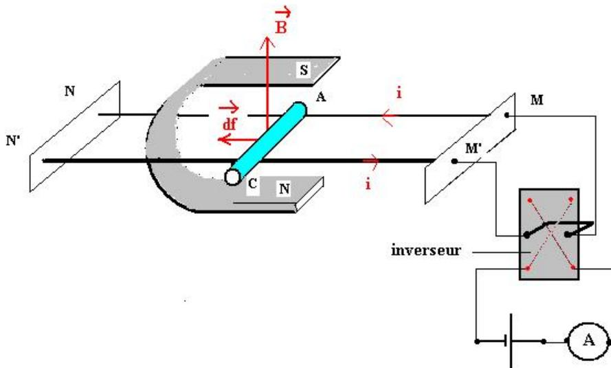
Changer le sens du courant et le sens du champ en retournant l'aimant Déterminer à chaque fois le sens de  $dF$  en utilisant la méthode de la main droite (ou la «règle des trois doigts») Vérifier le sens de déplacement du conducteur
