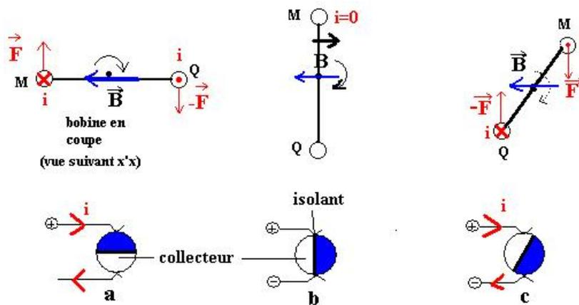
Deux balais diamétralement opposés frottent sur le collecteur et sont connectés aux bornes d'un générateur de courant continu. Le circuit est placé dans un champ magnétique  $B$ .
