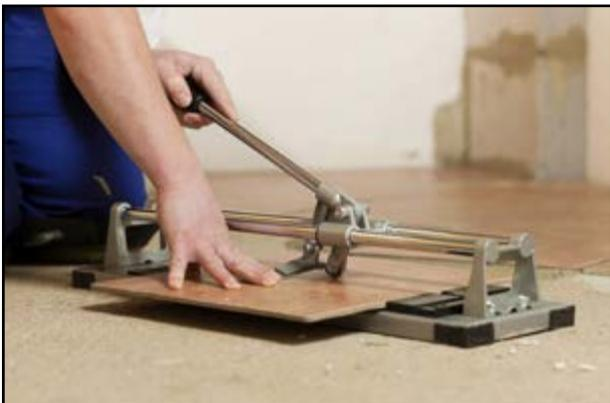
Le coupe-carrelage, ou carrellette, permet avec sécurité et simplicité, après un petit apprentissage, de couper des carreaux pour les ajuster aux dimensions souhaitées. C'est un simple chariot monté sur un rail qui, en se déplaçant, actionne une mollette. Cette dernière, comme la roulette d'un vitrier, griffe et marque
