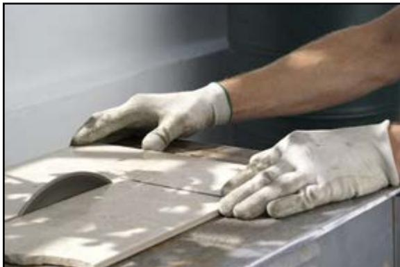
Le coupe-carrelage permet avec sécurité et simplicité, après un petit apprentissage, de couper des carreaux pour les ajuster aux dimensions de votre surface à carrelé. Le choix du coupe-carrelage est fonction de la nature du carreau à découper (surtout son épaisseur), de la nature des découpes (rectilignes, diagonales ou autres), puis de la surface à carrelé : le nombre de découpes que vous allez devoir répéter.
