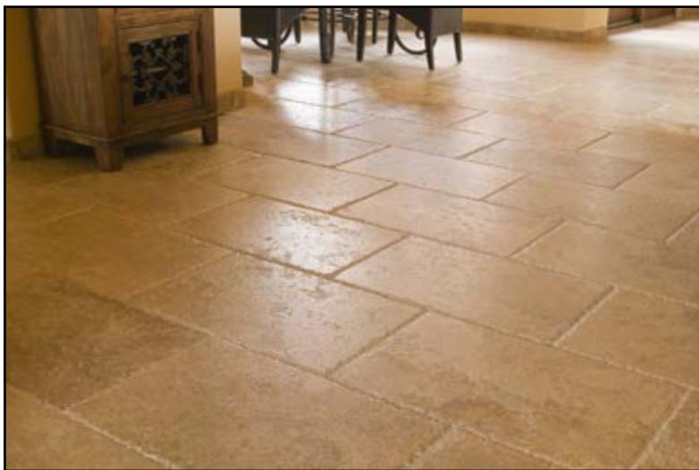
La terre cuite est un carrelage céramique constitué d'argile ordinaire, jaune, ocre ou rouge, mélangée à du sable. Elle est cuite en une seule cuisson entre 850 °C et 900 °C. C'est un matériau poreux, qui, pour être utilisé en carrelage, doit être traité contre l'humidité et les taches.
